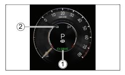
$\ll$  EV DRIVE » (1) et jauge de batterie haute tension (2) sur le combiné d'instruments.
